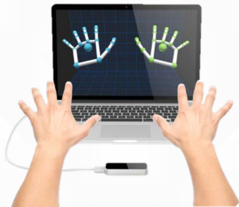
LEAP Motion トラッキングセンサー (Node.js 利用)
